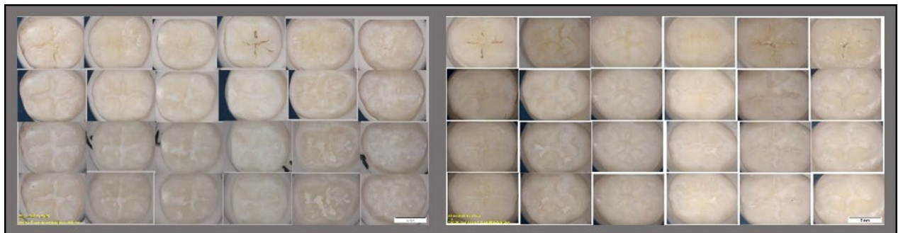
Abb. 17: Lichtmikroskopische Aufnahmen von mit Helioseal F (links) und Helioseal F Plus (rechts) versiegelten Zähnen - alle Versiegelungen wurden während 5 Sekunden bei 2000mW/cm 2 gehärtet. Von oben nach unten in Reihen (n=6): Vor Versiegelung, nach Versiegelung, nach Temperaturwechselbelastung und nach Zahnbürstensimulation. 26
